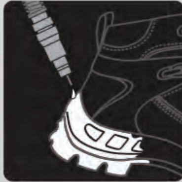
Inyección de suela
