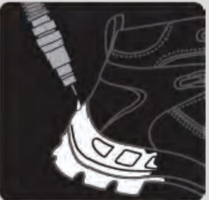
Inyección de suela
