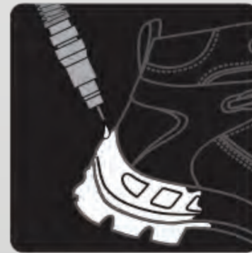
Inyección de suela
